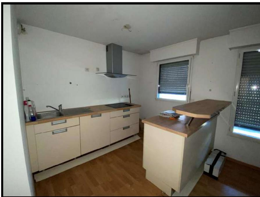
Ce coin cuisine est éclairé par un châssis de fenêtre un ouvrant en aluminium avec système oscillo-battant, double vitrage, persienne à tringle au droit de l'ensemble.
